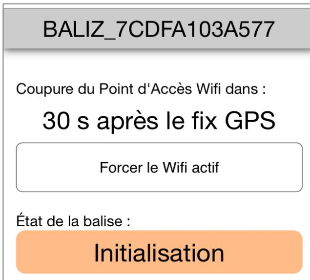
Pour effectuer des opérations telles que la vérification du bon fonctionnement de la BALIZ ou la mise à jour du micrologiciel, il est possible de forcer le point d'accès Wifi actif pendant 900 secondes en cliquant sur le bouton « **Forcer le Wifi actif** ». Cela permet d'éviter d'être déconnecté au bout de 30 secondes :
